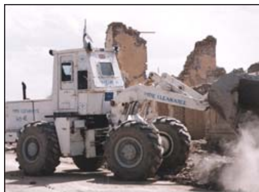
Очистка от камней с помощью бронированного фронтального погрузчика, Кабул (Афганистан)
