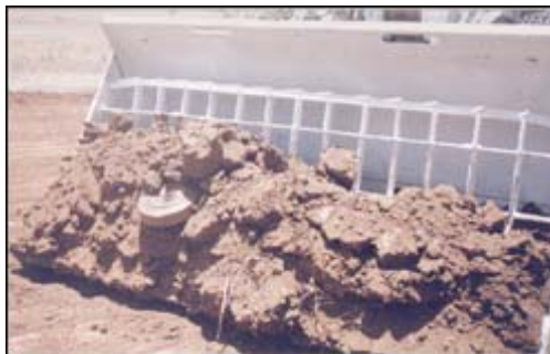
В компании HALO адаптировали бронированные ковши, установив на них решетки для отделения противотанковых мин от почвы и противопехотных мин, для применения в зонах, где могут эпизодически встречаться противотанковые мины.
