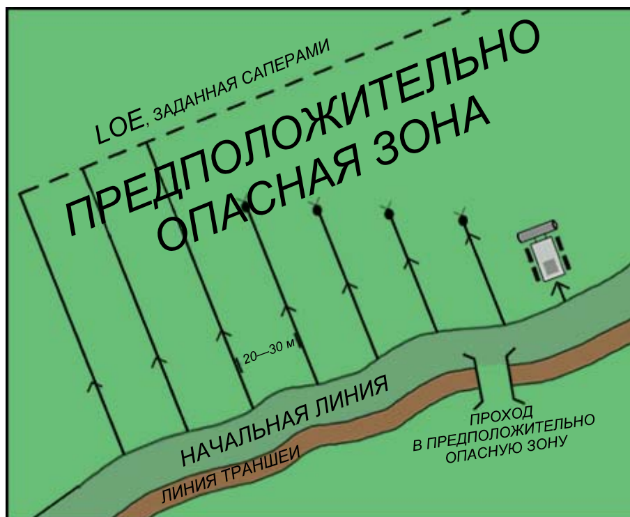
Рис. 5. Траление перпендикулярно начальной линии до заранее определенной ЛОЕ на участке, где предполагается наличие противопехотных мин. Когда минный трал выявит наличие противопехотных мин и приблизительную схему минирования, производится развертывание активов по очистке. На приведенном здесь рисунке данный тип траления непосредственно предшествует очистке с помощью бронированного ковша и является неотъемлемой частью этого процесса.
