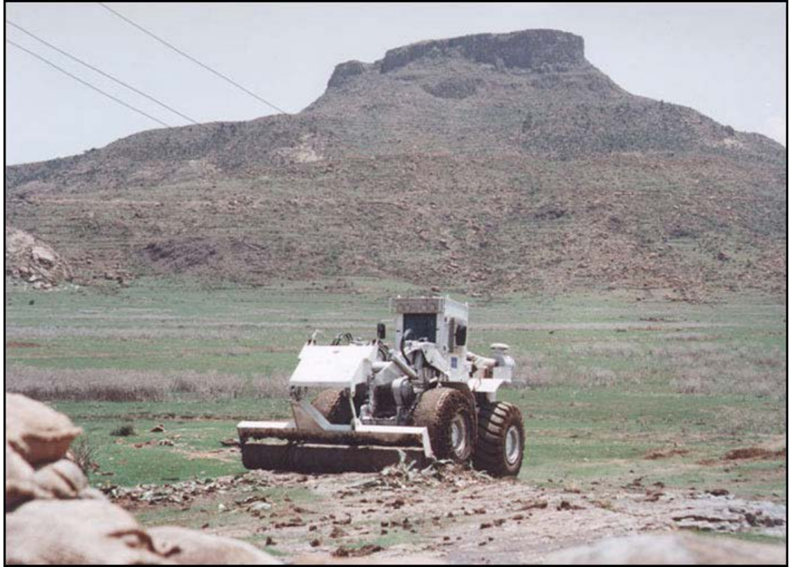
مدحلة بيرسون معلقة بمركبة تحميل أمامي من نوع CASE تعمل بالقرب من سينافي، إريتريا.
