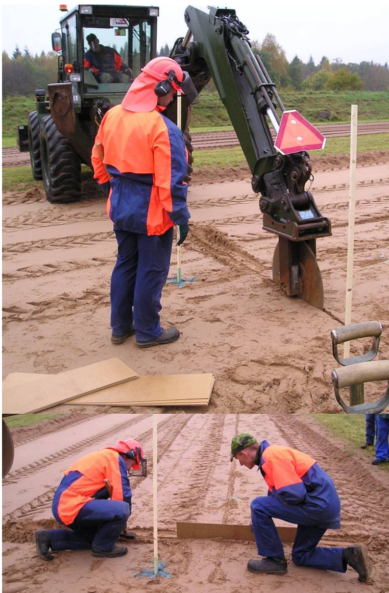
Рисунок А.3. Правильная установка панелей из древесноволокнистой плиты
