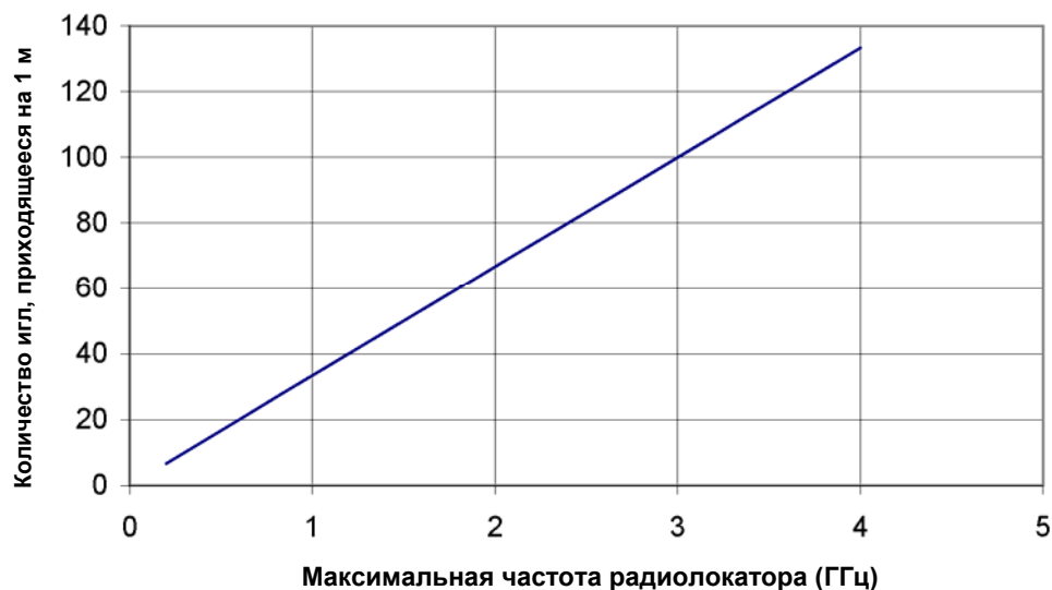
Рисунок В.7. Зависимость количества игл, приходящегося на 1 м длины стержня, от максимальной частоты GPR
