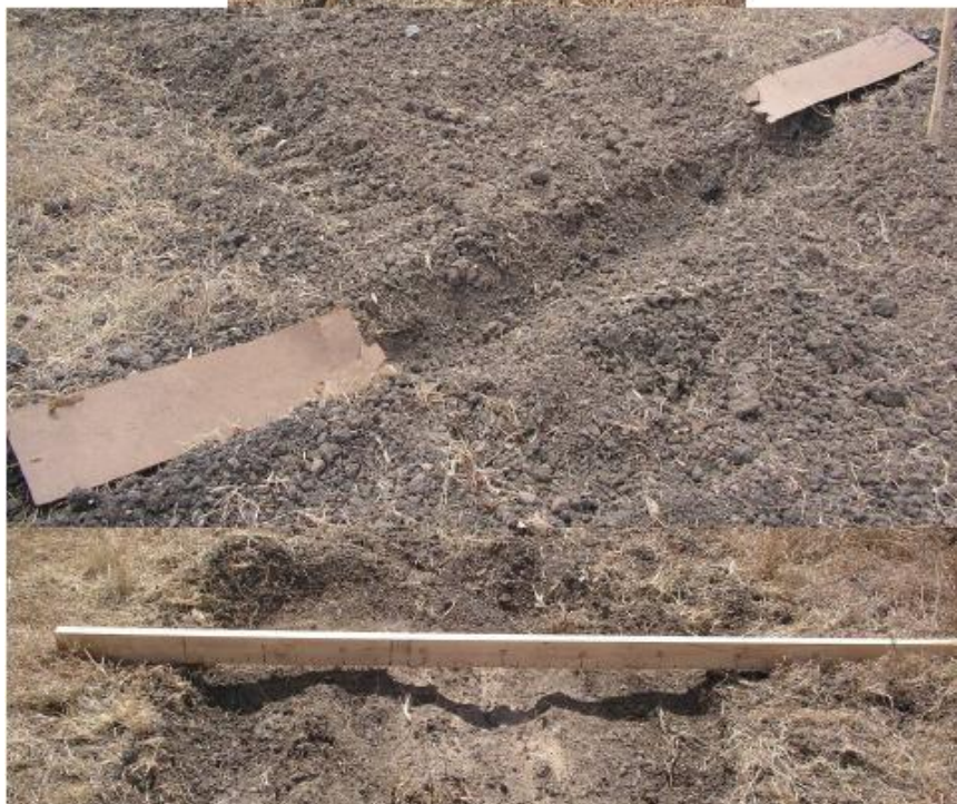
Figure 4 : installation incorrecte des panneaux, conduisant à des résultats erronés
