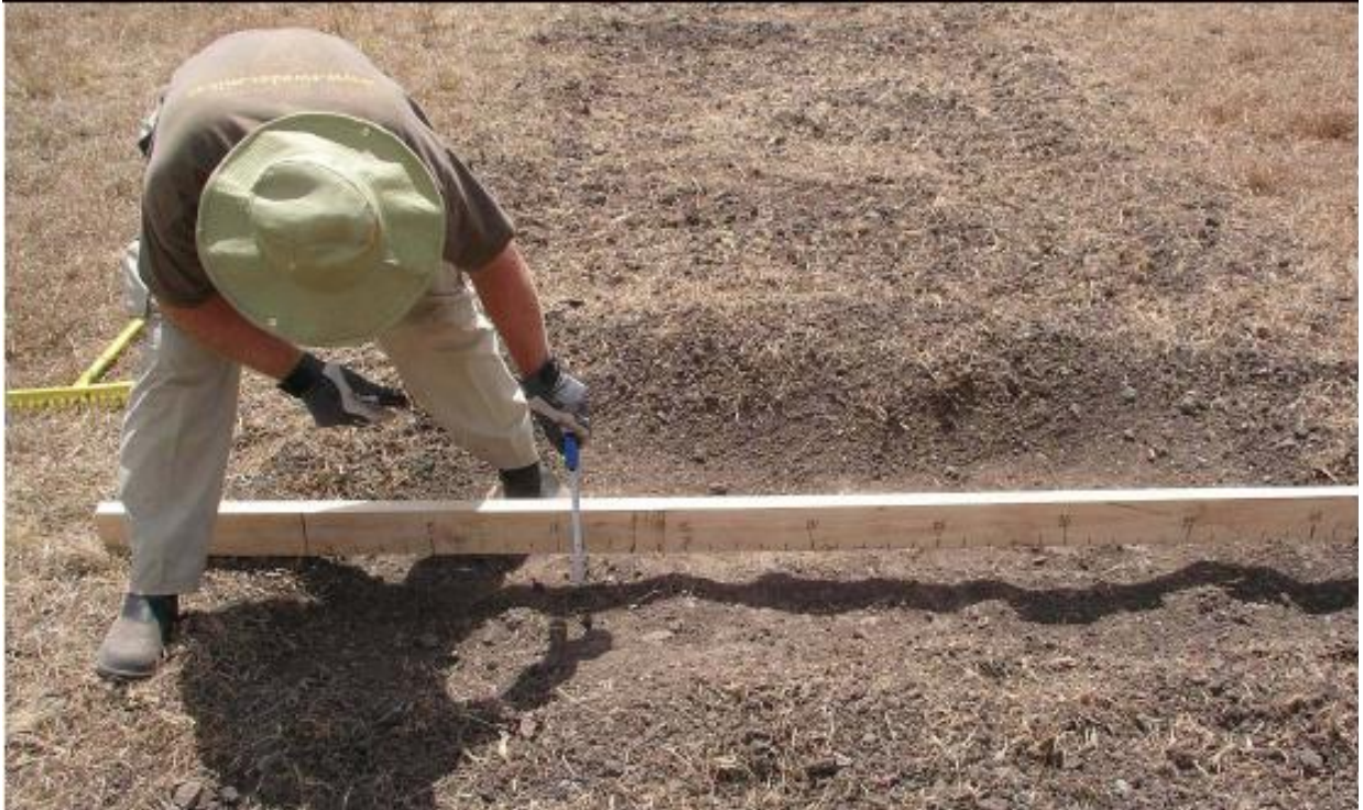
Image 1 : Mesure directe de la profondeur de pénétration
