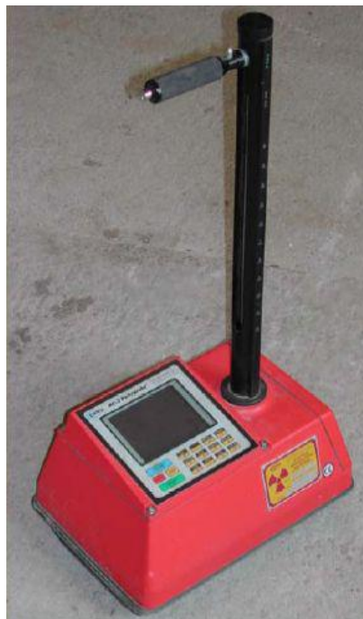
Figure 5 : Densimètre nucléaire modèle MC-3 Portaprobe utilisé par le SWEDEC pour surveiller les niveaux de compactage du sol des couloirs de test standards
